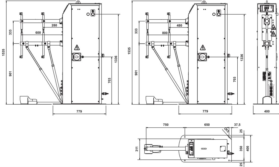
**PUNTATRICI PNEUMATICHE RETTILINEE - LINEAR ACTION AIR OPERATED SPOT WELDERS**
