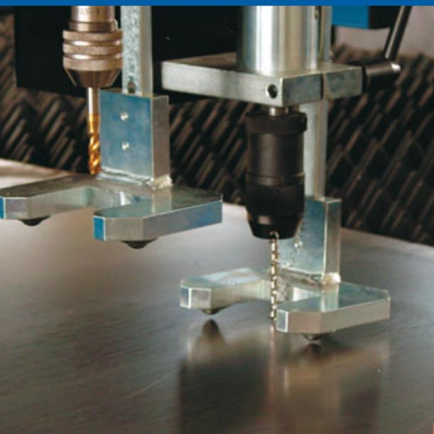
Vrtací vřeteno společně se závitovacím vřetenem jsou umístěny společně na suportu se samostatným pohonem. Posuv a otáčky vřeten jsou plně řízeny systémem. V sadě instrukcí jsou všechny funkce běžné u CNC obráběcích center (vrtací a závitovací cykly apod.). Vrtání a závitování lze je využívat jako doplněk pálení nebo jako samostatnou technologii.
