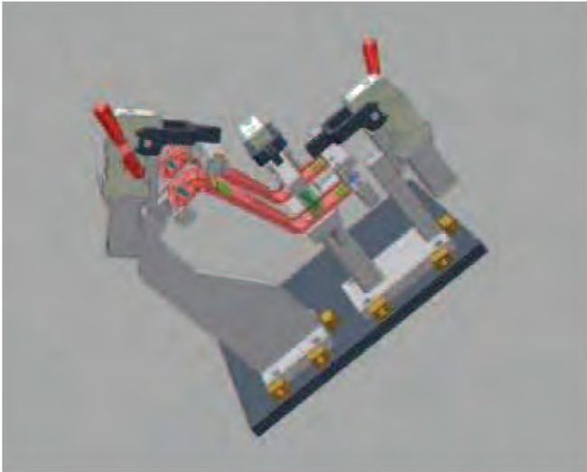
Automatická zváracia bunka. Zváranie úchytov bezpečnostných pásov.
