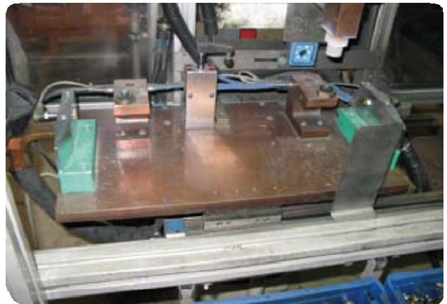
Nástroj pre 2 zvárané puzdrá na autosedačky v automatickom cykle.
