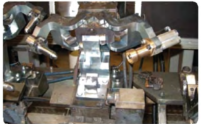
Modifikácia robotizovanej zvárackej bunky. Geo kontrolný upínač.
